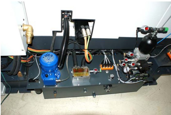
Bildunterschrift: An der Rückseite der Maschine befindet sich das neu konzipierte Hydraulikaggregat
