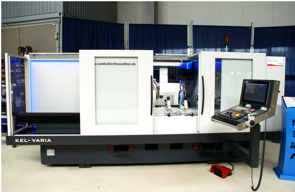
Die Kellenberger Universalrundschleifmaschine KEL-VARIA mit Fagor-Steuerung nach dem Retrofit
